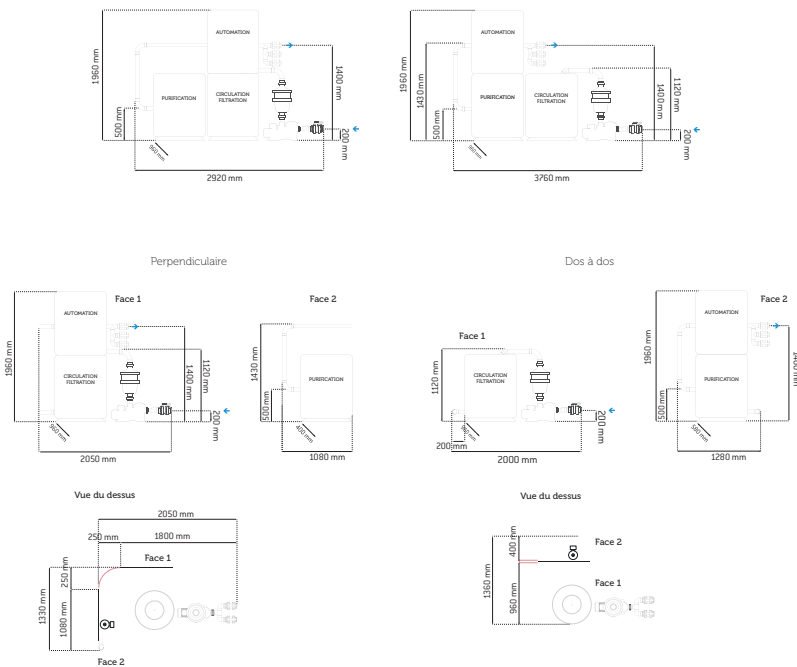
FIG. 6: VARIANTEN DER VITII-MONTAGE IN 2 ETAGEN FÜR VITII 15
