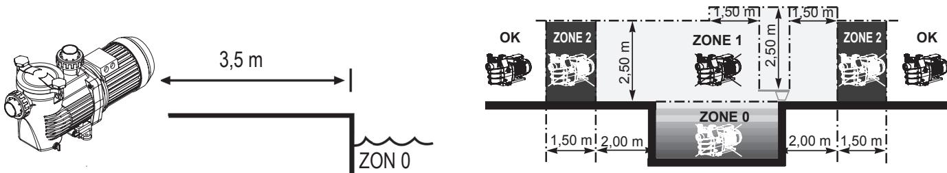
Installera pumpen i ett torrt utrymme med god ventilation. Motorn kräver att luften får cirkulera fritt runt den för naturlig ventilation. Kontrollera regelbundet att inga föremål, löv eller skräp blockerar motorns kylsystem.
